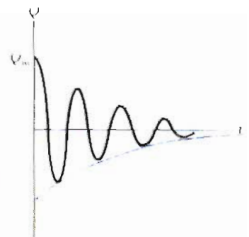
Figura 32.18 Carga como función del tiempo para un circuito RLC amortiguado. Esto sucede cuando R \ll \sqrt{4LC} . La curva Q contra t es una gráfica de la ecuación 32.35.
