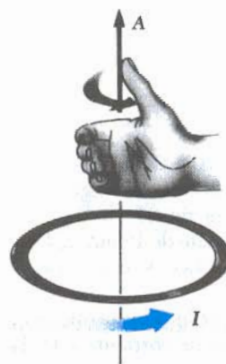
Figura 29.11 Regla de la mano derecha para determinar la dirección del vector \mathbf{A} . El momento magnético \boldsymbol{\mu} está también en la dirección de \mathbf{A} .
